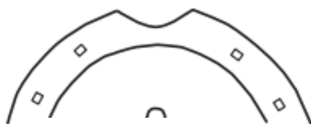
過大な鉄唇基部の凹み
