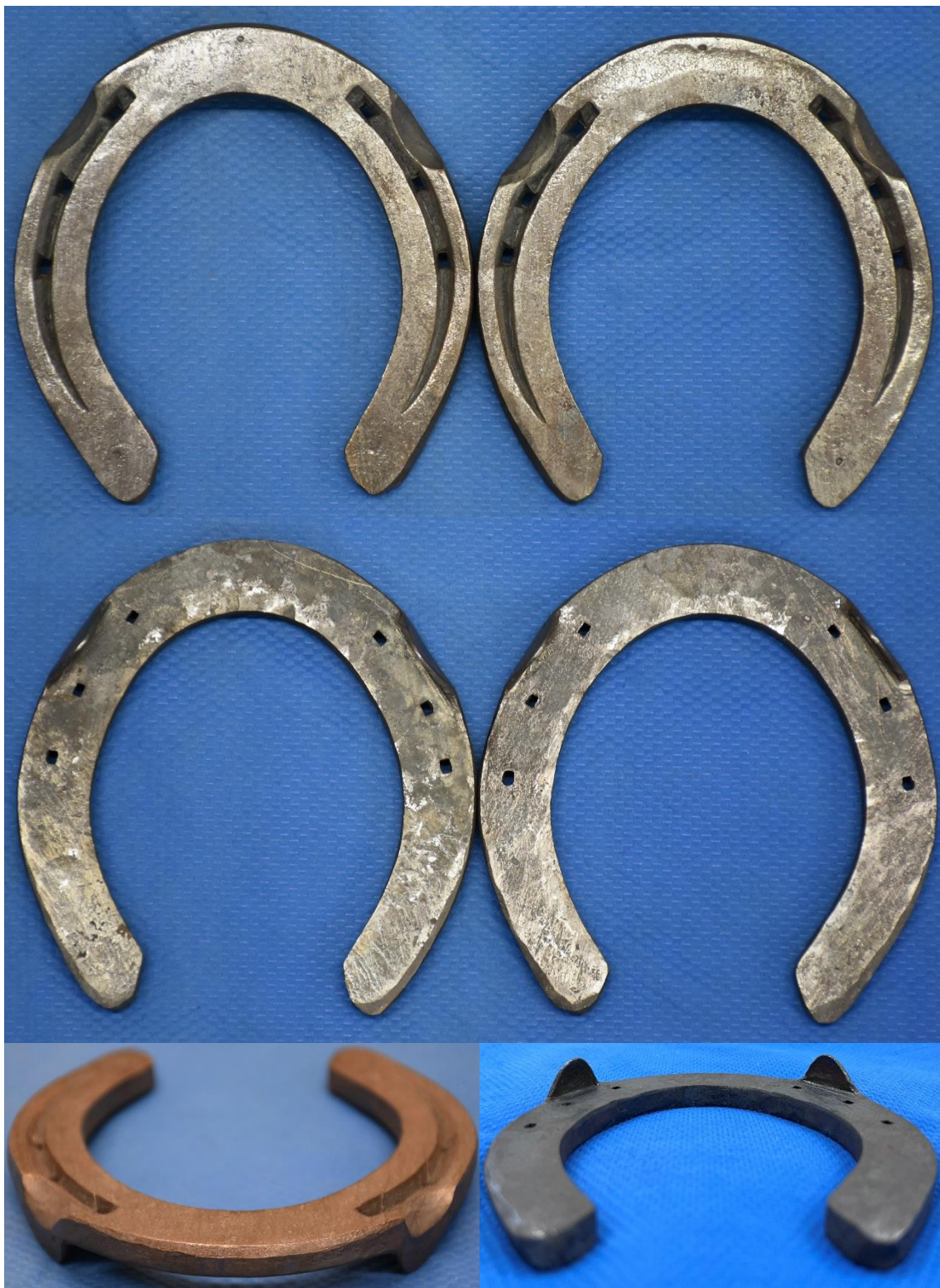
後肢蹄鉄(横径:123mm、縦径:127mm、鉄頭部の幅:20mm)
